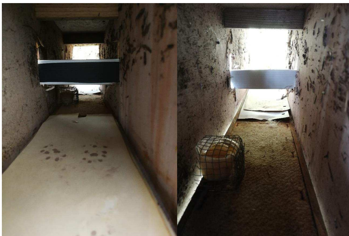
Vue de l'intérieur d'un tunnel avec à gauche des empreintes de Vison d'Europe et à droite l'appât au premier plan et la plaquette à poils au-dessus de la feutrine d'encre (GREGE/LIFE VISON)
