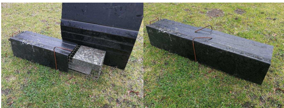
Vue des protections développées servant à totalement isoler les animaux capturés des intempéries (GREGE/LIFE VISON).
