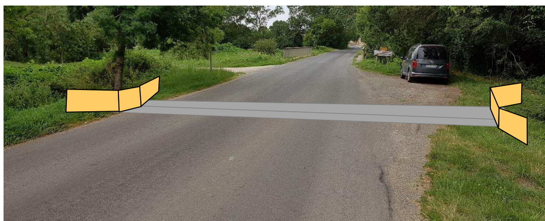
Figure 12:représentation des entonnements en palissades bois
