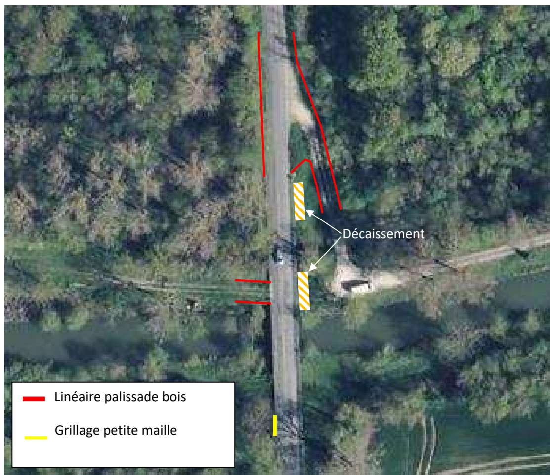
Figure 12:représentation des protections du franchissement 54
