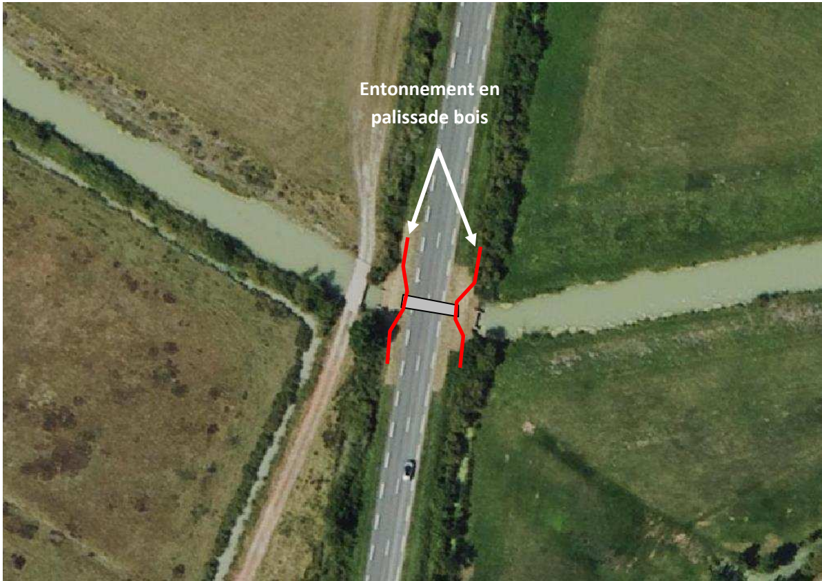
Figure 6:représentation de l'emplacement des entonnements en palissade bois
